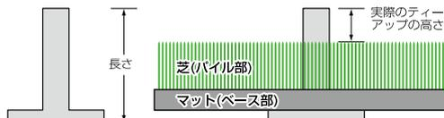
ティーの長さは上記の通り計測した数値を表示していますので、実際のティーアップの高さとは異なります。一般的なマットの場合ベース部が約5mm、芝部(パイル長)が約12~15mmありますので、ご使用されるマットの厚さを考慮してください
