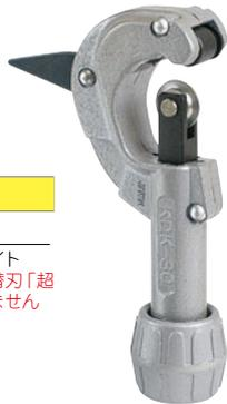
業務用に耐えられる超硬合金製刃を装着したモデルでクロモリブデン鋼製刃に比べ耐久性と切れ味が勝ります。また、刃厚が薄いため外形変化やバリが少なく仕上がります。
